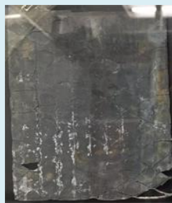
BATを投入一ヶ月後。サルフェーションはほぼ完全に除去され、バッテリーの能力も新品同等以上に復活。
